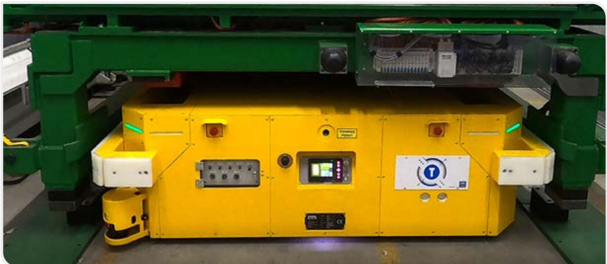
Fot. 1. // Przyrząd spawalniczy zadokowany na wózku AGV
