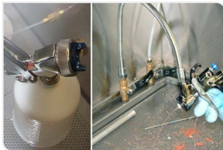
Fot. 3. // Myjka do narzędzi lakierniczych PROLAQ Auto umożliwia jednocześnie czyszczenie automatyczne i ręczne.
