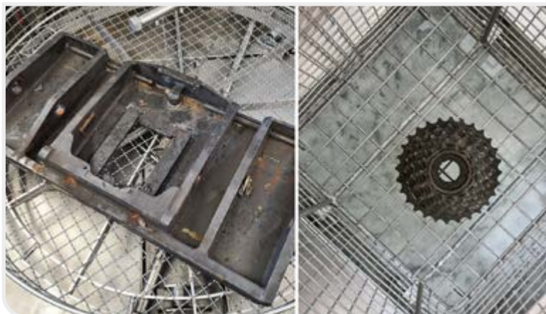
Fot. 2. // Automatyzacja czyszczenia części w działach utrzymania ruchu opiera się na urządzeniach wysokociśnieniowych i ultradźwiękowych.
